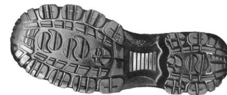
Bild B.2 — Profilierte Sohle des Prüfschuhs
