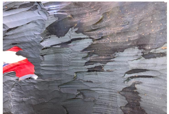
Oben: Richtungsabhängiger Materialabtrag der Innenoberfläche
