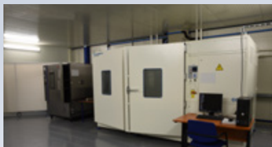
Klimatické testy např. dle PV 1200, 500h/120°C
