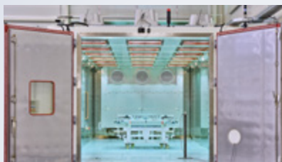
Solární simulace až do 6 přístrojových desek najednou nebo mnoha opěr
